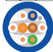
Rys. Przekrój kabla U/FTP
